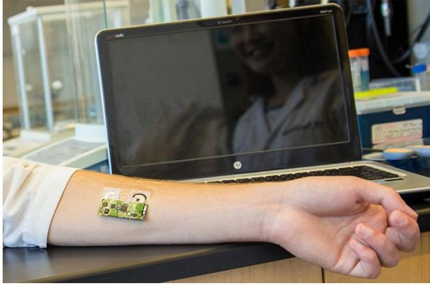
Este dispositivo portátil construido por la Universidad de California en San Diego puede detectar alcohol a través del sudor.
